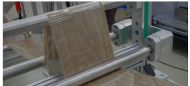
Herstellprozess eines flachsfaserverstärkten PET-Tapes
