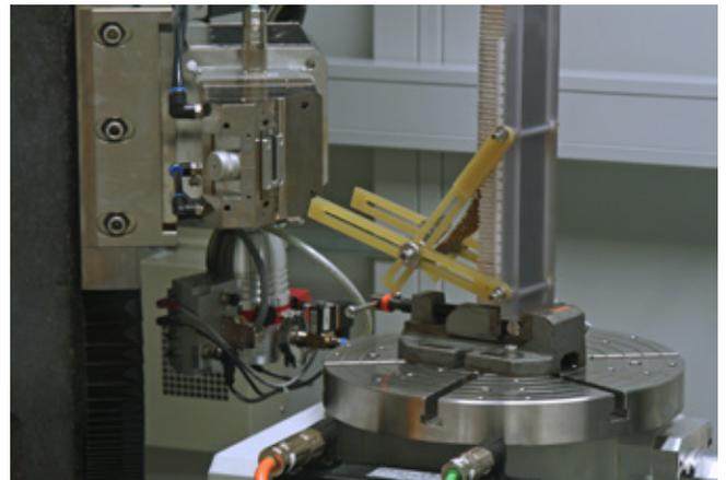
*Belastete Sandwichprobe mit teilweise abgelöster Deckschicht im SCB-Test innerhalb der Röntgen-CT-Anlage*
