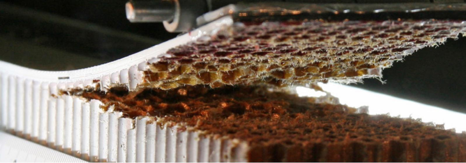
Sandwichprobe im Single-Cantilever-Beam-Test: Deckschicht-Ablösung bei sehr hohen Lasten durch Reißen des Aramidpapier-Wabenkerns unterhalb der Deckschicht
