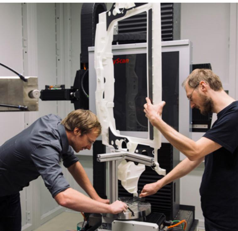
**28** | In-situ-Röntgen-Computertomographie verbessert Prüfverfahren für Hochleistungsverbundwerkstoffe
