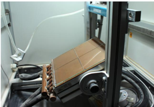
*Blick in die Staubkammer des Soiling-Teststands:
