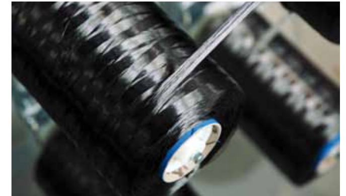
UD-Tapes aus faserverstärkten Kunststoffen werden zu besonders leichten und robusten Bauteilen verarbeitet.
