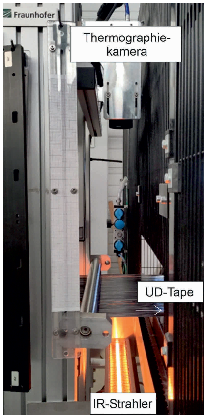
Der Transmissionsaufbau einer Inline-Thermographie. © Fraunhofer IMWS
