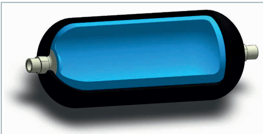
Ein Typ-IV-Druckbehälter besteht aus einem innenliegenden thermoplastischen Kunststoff-Liner, der die Gasdichtheit gewährleistet. Hochfeste Carbonfasern in einer duroplastischen Kunststoffmatrix werden im Wickelverfahren aufgebracht und bilden die tragende Behälterstruktur. © Hexagon Purus GmbH
