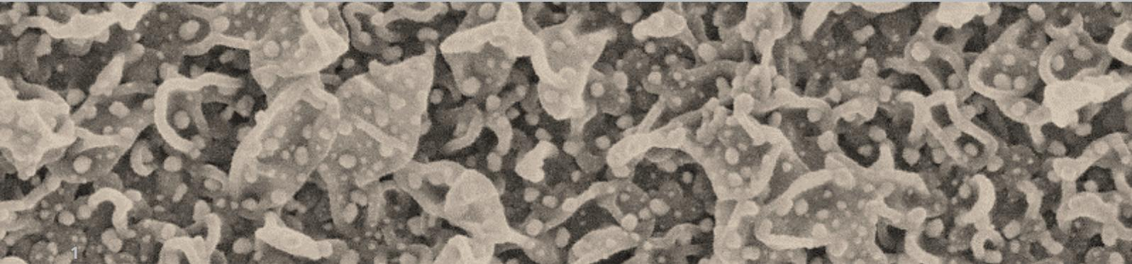
1 Polyamid-Oberfläche einer Filtrationsmembran mit charakteristischen Ausstülpungen und abgeschiedenen Silber-Nanopartikeln (REM, 30000x).
